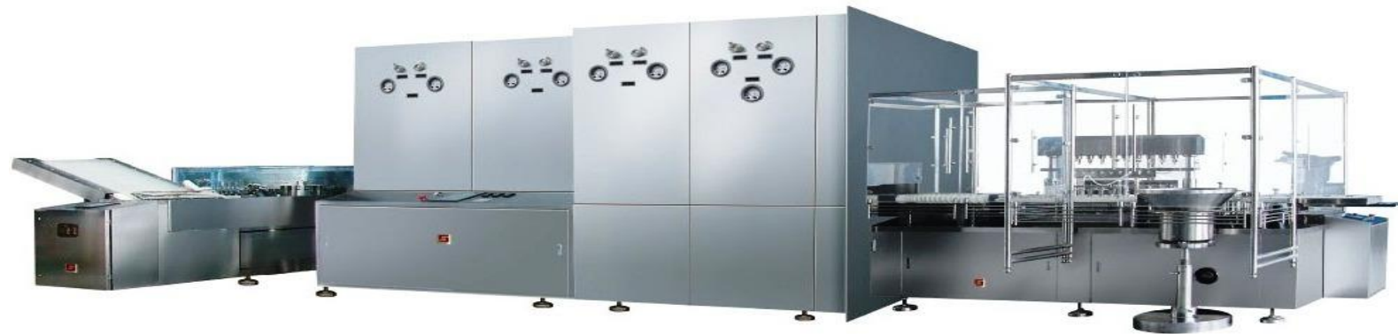
Línea de lavado, esterilización, llenado para frascos viales y/o ampollas
